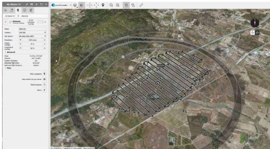
Figura 8 - Planeamento de voo numa parcela de olival, utilizando o software eMotion® desenvolvida pela senseFly . Fonte: Fernandez et al. (2019a).
