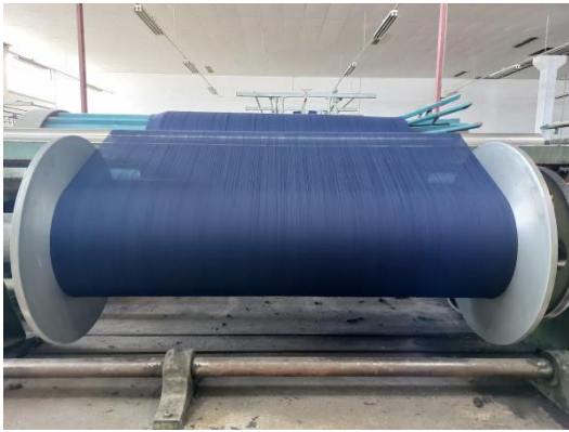
Imagem 64- Processo de enrolar a teia Fonte: Própria
