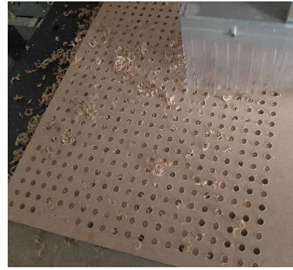
Figuras 191 e 192 - Corte das peças da moldura e da placa de MDF na fresadora CNC
