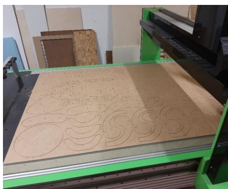
Figuras 82 e 83 - Peças cortadas na fresadora CNC; algumas maquetas montadas
