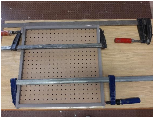
Figuras 193 e 194 - Montagem e colagem da moldura e das camadas de cortiça
