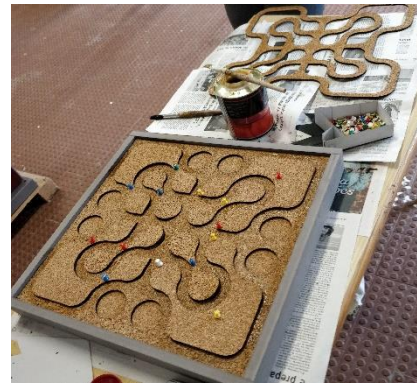
Figuras 193 e 194 - Montagem e colagem da moldura e das camadas de cortiça
