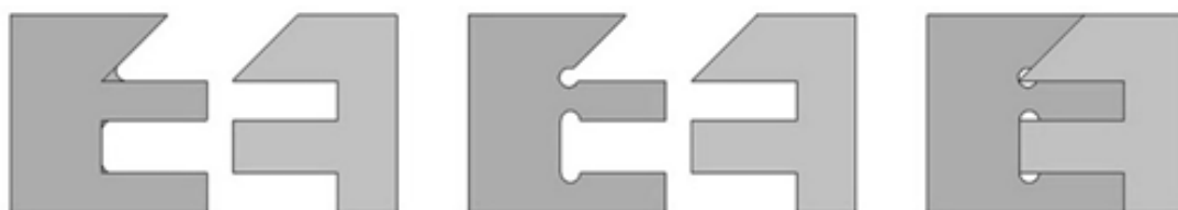
Figura 17 - Restrição: Cantos arredondados ( Dog bones )
