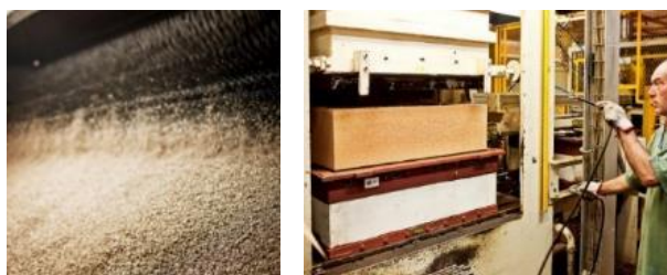
Figuras 157 e 158 - Cortiça a ser triturada; Desmoldagem do aglomerado
