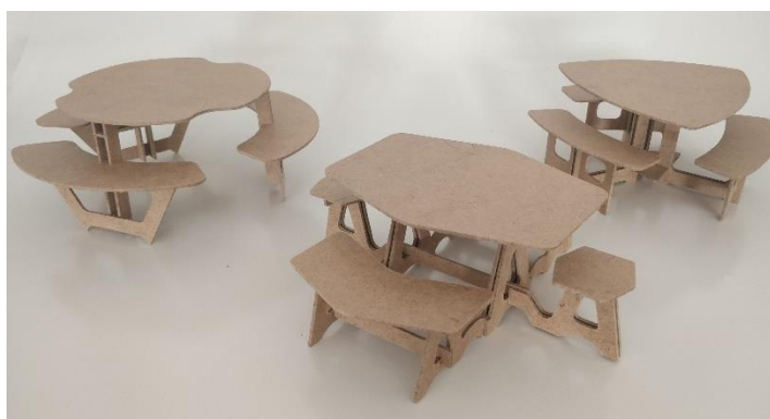
Figuras 82 e 83 - Peças cortadas na fresadora CNC; algumas maquetas montadas
