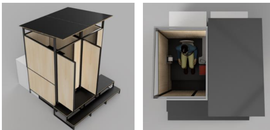
Figuras 221 e 222 - Visualização 3D da última proposta, com estudo prévio da plataforma de acesso, vista com as portas abertas (esquerda) e de cima (direita)
