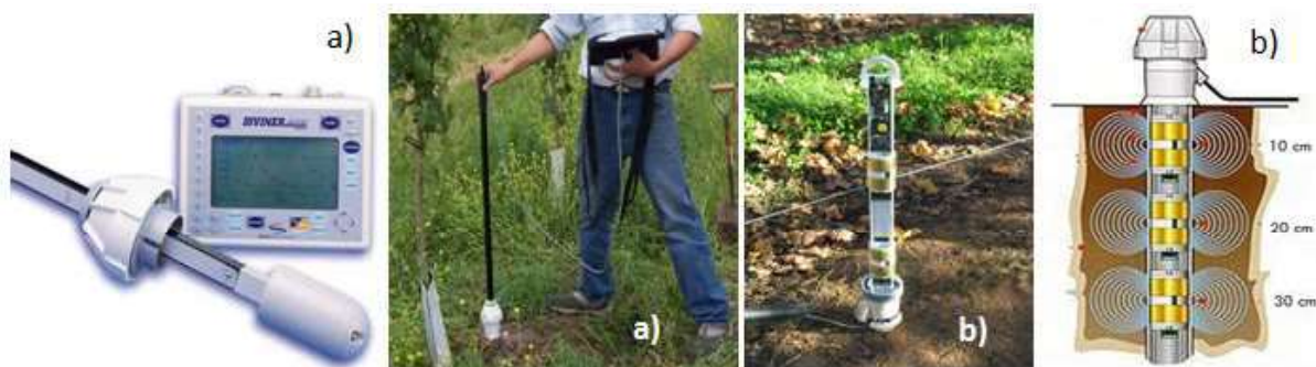
Figura 6.10 – Sondas FDR com os respetivos tubos de acesso, sonda DIVINER (a) e sonda ENVIROSCAN (b).
