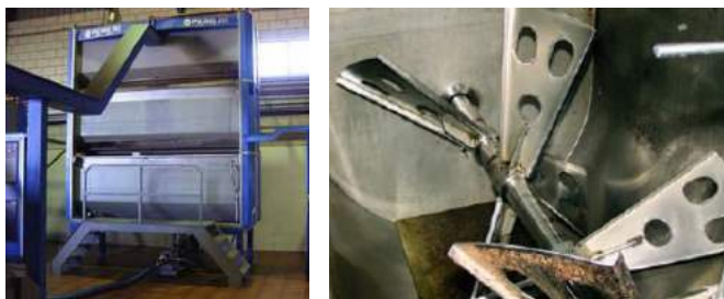
Figura 2. Aspeto de batedeira de 3 corpos e das pás do interior
