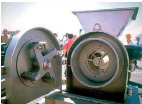
Figura 1. Exemplo de moinhos metálicos, caso particular de um moinho de martelos
