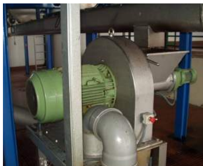
Figura 1. Exemplo de moinhos metálicos, caso particular de um moinho de martelos
