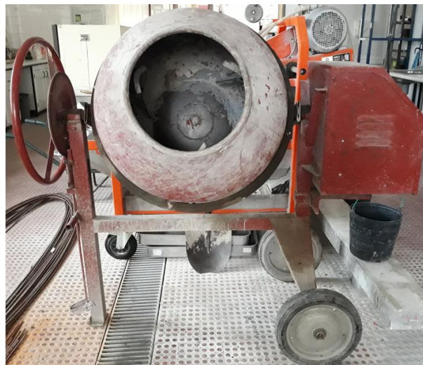
Figura 33 - Betoneira de eixo horizontal
