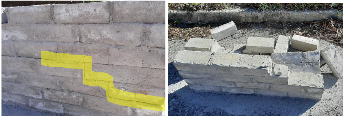
Figura 63 - Resultados das pancadas, com a massa 5,25kg. a) 1ª pancada; b) 2ª pancada.
