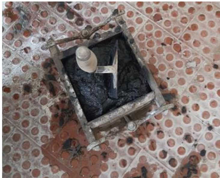
Figura 43 - Enchimento dos provetes
