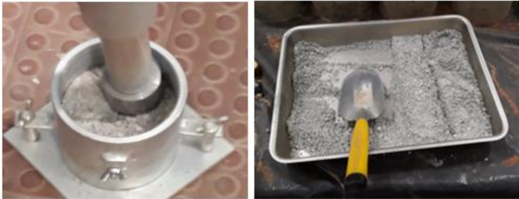
Figura 12 - Ensaio de compactação, LNEC E 197
