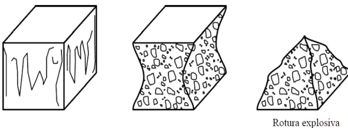
Figura 47 - Roturas satisfatórias de provetes cúbicos [23]
