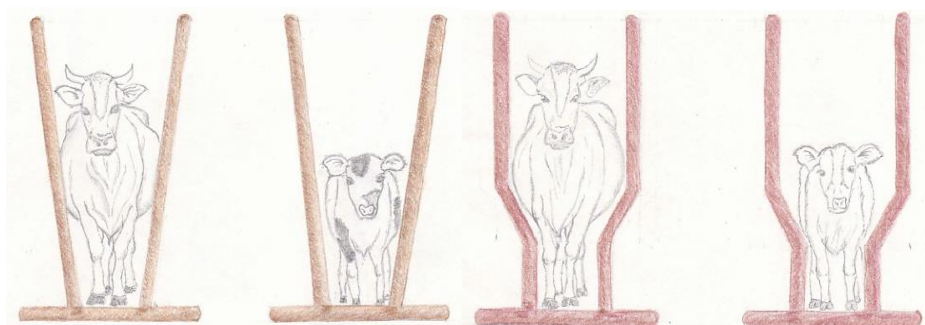
Figura 28. Manga de contenção com o perfil em V e Y para bovinos com diferentes idades e tamanhos.
