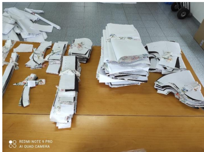
Figura 51- Disposição de todos os moldes organizados, para ir para a linha de produção.
