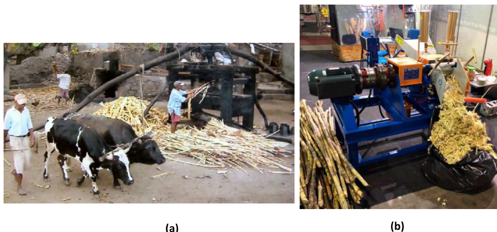
Figura 5: a) - Moenda tradicional- trapiche de Cabo Verde. Fonte: Jornal Expresso das Ilhas (19-01-2025); (b)- Moenda motorizada. Fonte: https://ranipierotti.com.br/ .
