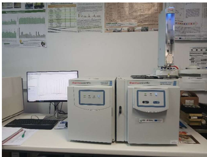
Figura 9: Comatógrafo de gases acoplado a espectrómetro de massa (Thermoscientific, TRACE 1600-ISQ7610)
